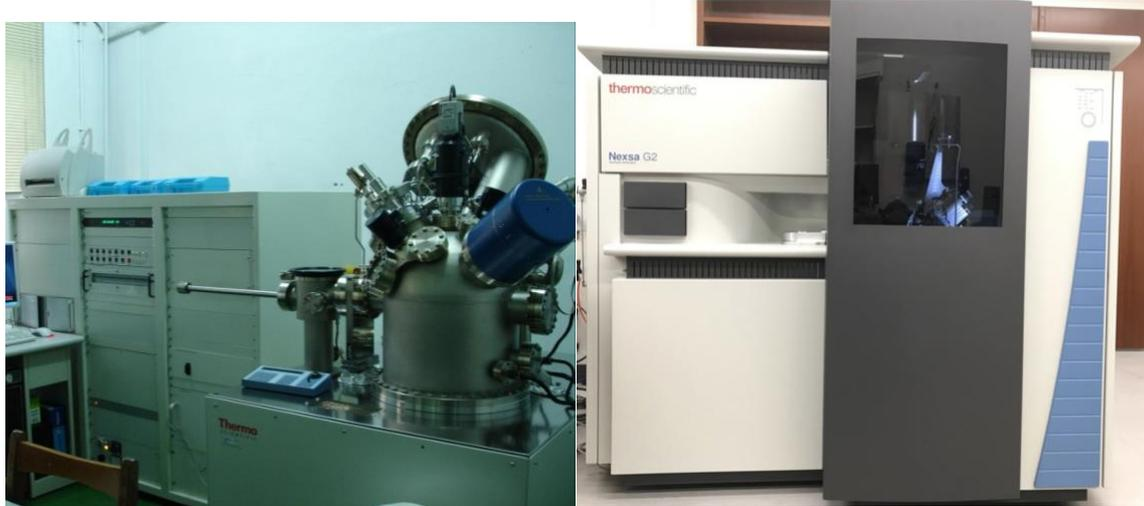
材料經由帶有能量的 X 光照射後形成光電效應，將內層軌域的電子激發產生光電子，只有在樣品表面所產生的光電子才能脫逸出而被測得，此被激發的光電子經偵檢器分析後，可測得光電子束縛能的能譜；由於不同元素、不同軌域所產生的光電子束縛能不同，所以可由束縛能得知此光電子來自於哪一種元素的哪一層軌域。
